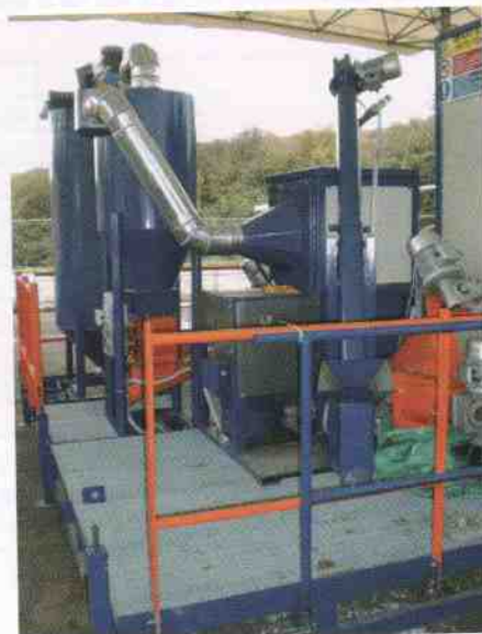
Figura 6 - Il primo impianto completo dimostratore REFOLO, presso l'Area della Ricerca CNR RM-1 nel Dicembre 2008: di fronte la coclea di carico, il micronizzatore (scatola grigia centrale) il tubo dell'aspiratore delle polveri e il ciclone (in azzurro) con il filtro a maniche di aspirazione
